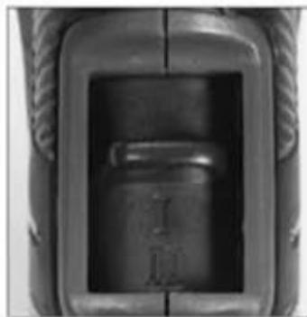
Технический фен WHP-2050 имеет механический выключатель режима обдува (рис. 4), который может быть установлен в одном из трех режимов. Положение «0» - выключено, положение «I» - поток воздуха в 300 л/мин, положение «II» - поток воздуха в 500 л/мин.
