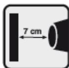
**При работе с техническим феном, устье сопла (1) рис. 1 должно быть удалено от обрабатываемой поверхности минимум на 7 см, так как воздушная пробка может привести к повреждению устройства.**
